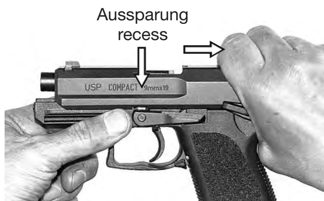
Lage Aussparung zu Verschlussfanghebel Position of the recess of the slide release
